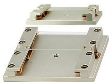
EM-Tec RG2 ツイン地質薄片ホルダー 岩石スライド 2 枚用トップリファレンスホルダー 最大 48×28mm、M4
